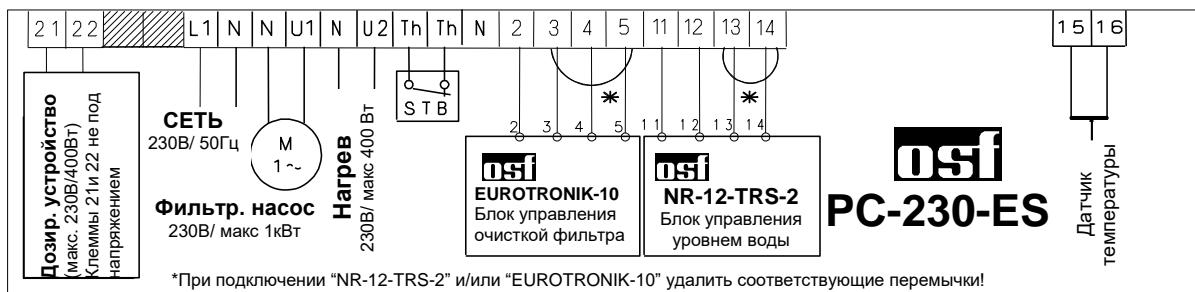
При подключении устройства тепловой защиты необходимо удалить перемычку между контактами *Th*. Если защита не используется перемычку необходимо прикрутить.
